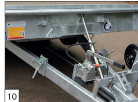
10 Standaard: hydraulisch kantelbaar, dubbelwerkend systeem incl. smoorventiel.
