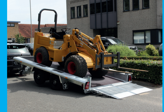
7 Standaard: oprijklep ca. 120 cm lang scharnierend aan de achterzijde met 2 uitneembare hoekkronen en instelbare sluitingen.
